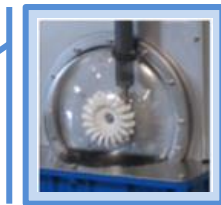
Fonctionnement de la roue Pelton en dynamique
